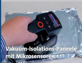
Vakuum-Isolations-Paneele mit Mikrosensoren
